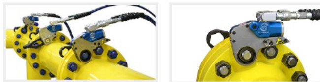
ตัวอย่าง Hydraulic Torque Wrench
